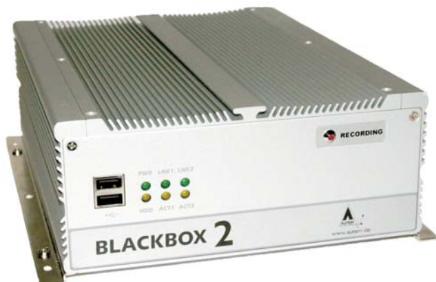
Bild 3: Das komplette Rechnersystem im massiven Aluminiumgehäuse.
