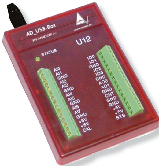
Bild 4: Erfassung externer Signale mithilfe der AD_USB-Box.
